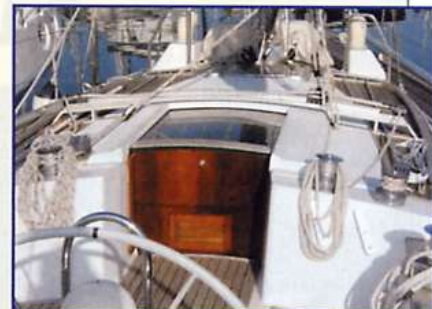
A sinistra, il pozzetto ha schienali alti ed ergonomici. Sotto, il trasto della randa è posto davanti al tambuccio.
