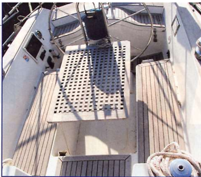
A sinistra, il pozzetto ha schienali alti ed ergonomici. Sotto, il trasto della randa è posto davanti al tambuccio.
